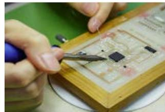
JIS-Z3851に基づく挿入実装、表面実装、端子実装の
